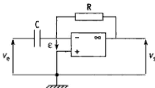
Donner l'équation différentielle liant  $v_s(t)$  et  $v_e(t)$ , pour un régime linéaire quelconque. Quel est le rôle de ce circuit ?
