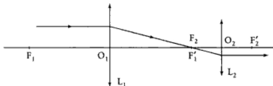
Un point source  $B$  à l'infini en dehors de l'axe du viseur – dans une direction  $\alpha$  – a pour image dans  $L_1$  un point  $B_1$  du plan focal image (plan de front de  $F'_1 \dots$ ), et ce point  $B_1$  a pour image dans  $L_2$  un point  $B'$  à l'infini dans une direction  $\alpha'$ , d'où la marche d'un pinceau de rayons lumineux :
