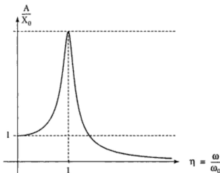
4. On a montré que le système proposé pouvait être caractérisé par un temps de réponse en régime transitoire de l'ordre de  $\tau = \frac{Q}{\omega_0}$  et par une bande passante en régime sinusoïdal forcé égale à  $\Delta\omega = \frac{\omega_0}{Q}$  ( $Q \gg 1$  pour la réponse en amplitude). On a donc :
