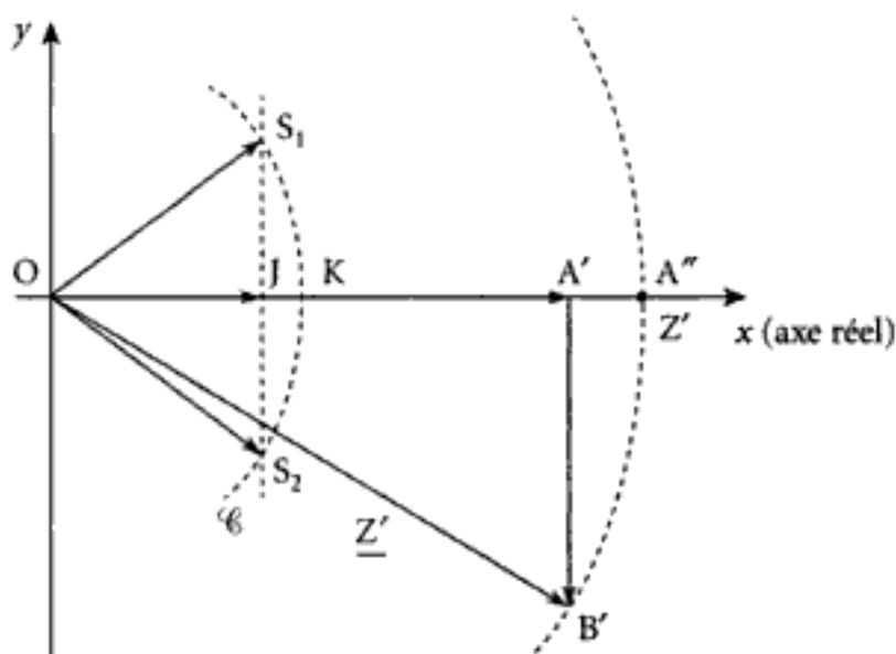
On a  $OA' = R'$  et  $A'B' = \frac{1}{C'\omega}$ . On trace alors le cercle  $\mathcal{C}$  de centre O et de rayon  $OK = Z = \sqrt{\frac{R}{R'}}Z' < (Z' = OA'')$ . L'impédance  $\underline{Z}$  est représentée par un vecteur  $\vec{OS}$  dont l'extrémité S doit se situer sur ce cercle avec :
