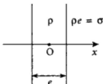
2. Remarquons tout d'abord que la distribution de charges ne dépendant que de  $x$ , les plans passant par  $M(x, y, z)$  et contenant  $\Delta$  parallèle à  $\vec{u}_x$  (cf. 1.) restent des plans de symétrie. Il en résulte que l'on a toujours :  $\vec{E} = E(x)\vec{u}_x$  le système restant invariant par translation selon  $Oy$  et  $Oz$ .
