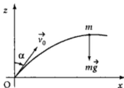
À une date  $t$  donnée, la position  $(x, z)$  de chaque projectile est fonction de  $\alpha$ . L'équation vérifiée par les coordonnées de tous les projectiles s'obtient en éliminant  $\alpha$  entre les deux équations du mouvement :
