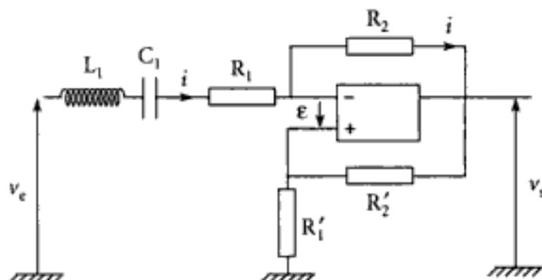
D'où, en remarquant que le même courant  $i$  traverse  $R_1$  et  $R_2$  :
