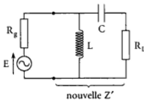
On veut  $\underline{Z}' = R_g$  ou  $\underline{Y}' = \frac{1}{\underline{Z}'} = \frac{1}{R_g}$
