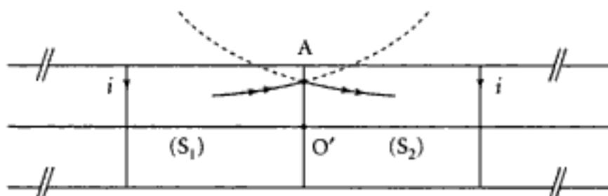
Le solénoïde  $S_1$  crée en A le champ  $\vec{B}_1$ , le solénoïde  $S_2$  le champ  $\vec{B}_2$ . Ces champs sont contenus dans le plan défini par  $O'z$  et  $O'A$ , et ils sont symétriques par rapport à  $A'z$ . De plus, on a  $B_{1z} = B_{2z} = B_z(r)$  grandeur que l'on cherche à déterminer.
