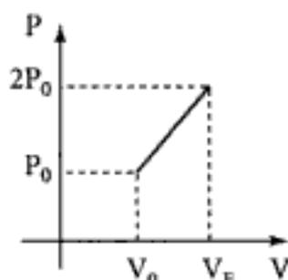
2. b. Le travail mécanique  $W_1$ , algébriquement reçu par le gaz au cours du chauffage (transformation quasi statique) est donné par :
