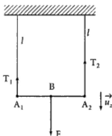
Et pour  $F \neq 0$ , il vient :  $F = (k_1 + k_2)(l - l_0) = (k_1 + k_2)\Delta l$  où  $\Delta l$  représente l'allongement du système.
