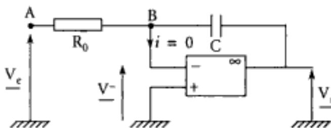
L'AO étant idéal,  $i = 0$  dans l'entrée inverseuse, et un même courant traverse la résistance  $R_0$  et la capacité  $C$ , d'où :
