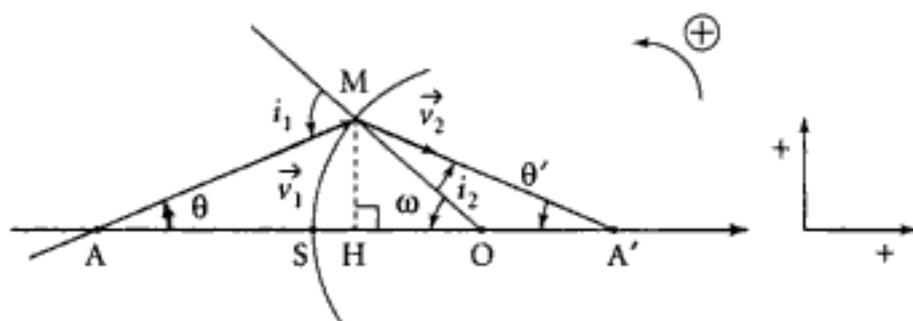
Dès lors :  $\omega \# \frac{\overline{HM}}{\overline{HO}}$ ,  $\theta \# \frac{\overline{HM}}{\overline{AH}}$  et  $\theta' \# \frac{\overline{HM}}{\overline{HA'}}$  (posons  $\delta = \overline{HM}$ ).
