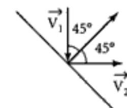
• La représentation classique du rebond élastique sur un obstacle n'est géométriquement simple que dans le référentiel où l'obstacle est fixe, d'où l'intérêt d'opérer le changement de référentiel correspondant.
