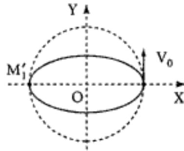
3. Dans un premier temps, la particule décrit l'arc  $\widehat{M_0EM_1}$  de l'ellipse de foyer O caractérisée au 1. b. Elle revient sur le cercle de rayon  $R$  en un point  $M_1$  symétrique de  $M_0$  par rapport à l'axe OE de cette ellipse. La conservation de l'énergie implique (puisque de plus  $OM_1 = OM_0 = R$  et donc  $E_p(M_1) = E_p(M_0)$ ) :
