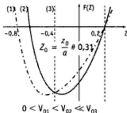
D'autre part,  $Z_{\min}$  tend vers  $-\frac{z_0}{a}$  quand  $V_0$  augmente « indéfiniment ». En effet pour une vitesse initiale suffisamment importante on pourra négliger l'effet de la pesanteur  $\frac{1}{2}mV^2 \gg mga$  et on retrouve à la limite le cas décrit au 1. pour lequel la trajectoire se situe bien entre  $-z_0$  et  $+z_0$ .
