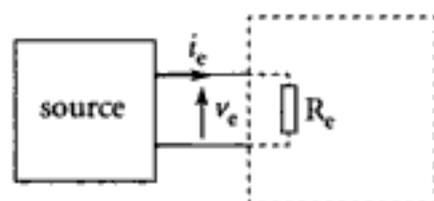
En régime continu établi, les condensateurs ne se laissent pas traverser par un courant : ils sont alors équivalents à des coupe-circuit. Le montage devient :
