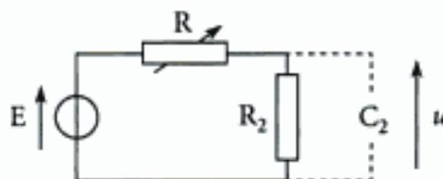
Pour  $R = R_2$ , on a  $u = \frac{E}{2}$  (diviseur de tension) et la déviation verticale devient  $\frac{\Delta}{2}$ .
