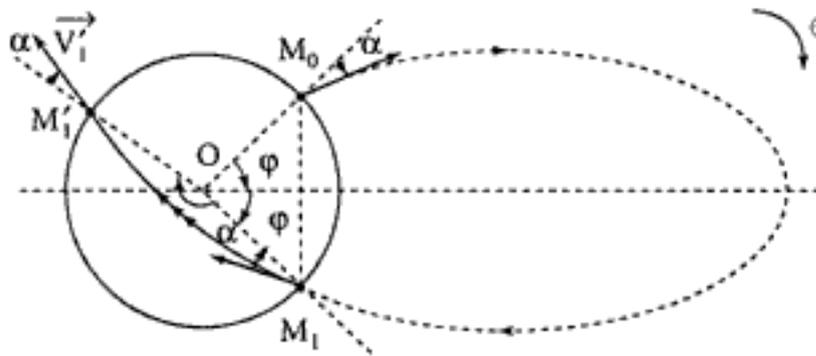
La particule ressort en  $M'_1$  avec une vitesse  $\vec{V}'_1$  telle que  $\|\vec{V}'_1\| = V_0$  (conservation de l'énergie) et  $(\overrightarrow{OM}'_1, \vec{V}'_1) = \alpha$  (conservation du moment cinétique). On est alors ramené à la même situation qu'en  $M_0$ , la particule redécrivant un arc d'ellipse de foyer O obtenu à partir de l'arc  $M_0EM_1$  par une rotation d'angle  $\Lambda = 2\varphi + \psi$ .
