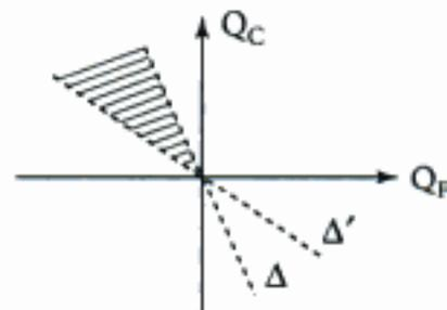
Une telle machine fonctionnera donc avec  $Q_C > 0$  et  $Q_F < 0$ , c'est-à-dire en prélevant de l'énergie thermique à la source chaude et en la restituant à la source froide.
