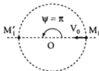
– Pour  $V_0$  suffisamment grand ( $\frac{1}{2}mV_0^2 \gg \frac{mK}{R}$ , soit  $\eta^2 \gg 1$ ), la particule présente un déplacement quasi rectiligne. Elle ressort en  $M_1'$  tels que  $\psi = \pi - 2\beta$  (cohérent avec (6)).
