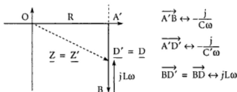
Cette dernière configuration n'est possible que pour  $A'B > A'C$  soit  $\frac{1}{C\omega} > \frac{1}{C'\omega}$ , c'est-à-dire pour  $C < C'$ . Dès lors, il vient :
