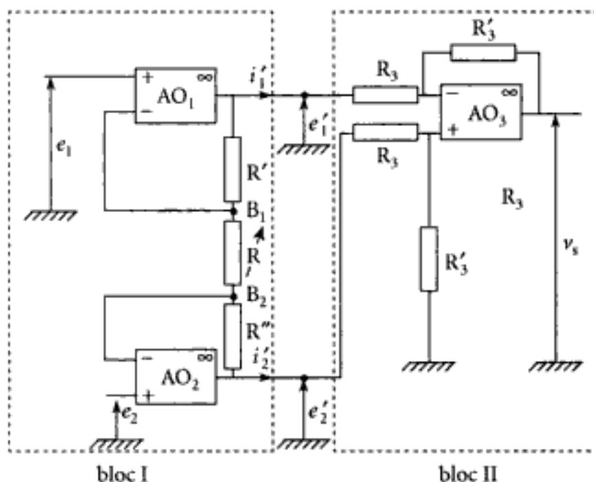
Le bloc II est identique au montage étudié au 1. a. Il présente un gain  $G_0 = \frac{R'_3}{R_3}$  et constitue un amplificateur différentiel tel que  $v_s = G_0(e'_2 - e'_1)$ .
