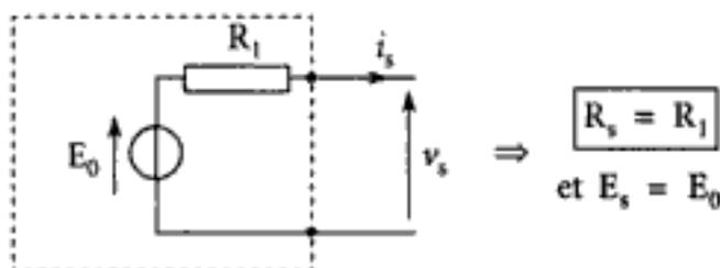
D'où  $R_s = R_1 = 10 \text{ k}\Omega$
