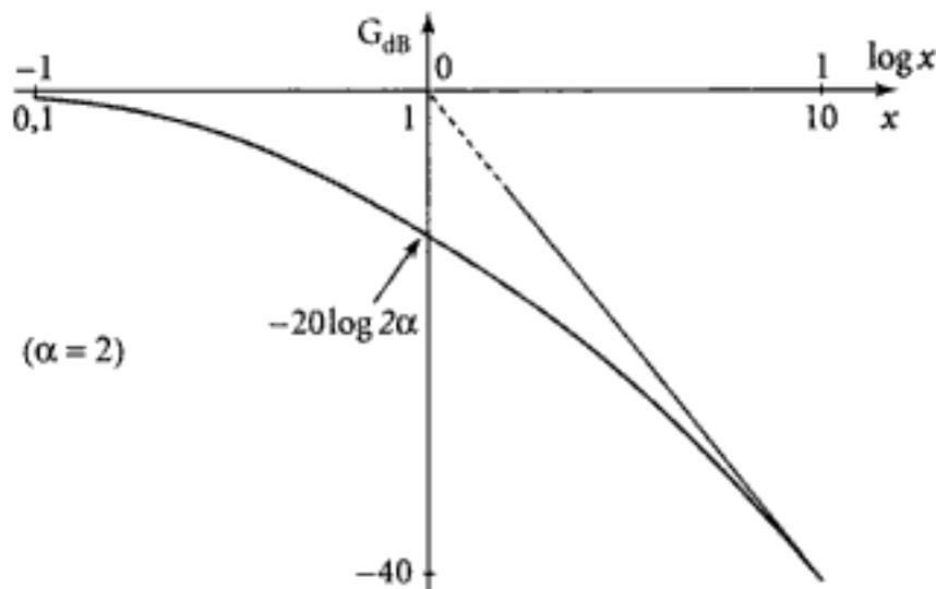
3. Le cas  $x = 0$  solution simple de  $\frac{dG_{dB}}{dx} = 0$  correspond à  $x_1 = 0$ , soit  $\alpha^2 = \frac{1}{2}$  (d'après le 2.), et  $\frac{C_1}{C_2} = 2$ .
