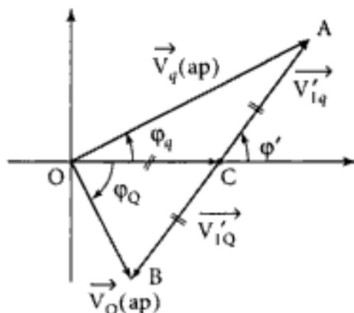
C est le milieu de AB et le triangle OAB est rectangle en O ( $OC = BC = CA$ ), on a donc, dans ce cas particulier, un angle de  $\frac{\pi}{2}$  entre les deux directions de vol des particules après interaction.
