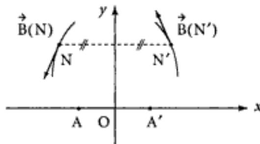
• Enfin, on peut considérer que le plan  $xOz$  est également plan de symétrie. Le champ  $\vec{B}$  est donc, sur l'axe  $x'x$ , perpendiculaire à cet axe, et en deux points  $S$  et  $S'$  du plan  $xOy$  symétriques par rapport à  $Ox$ , on a :
