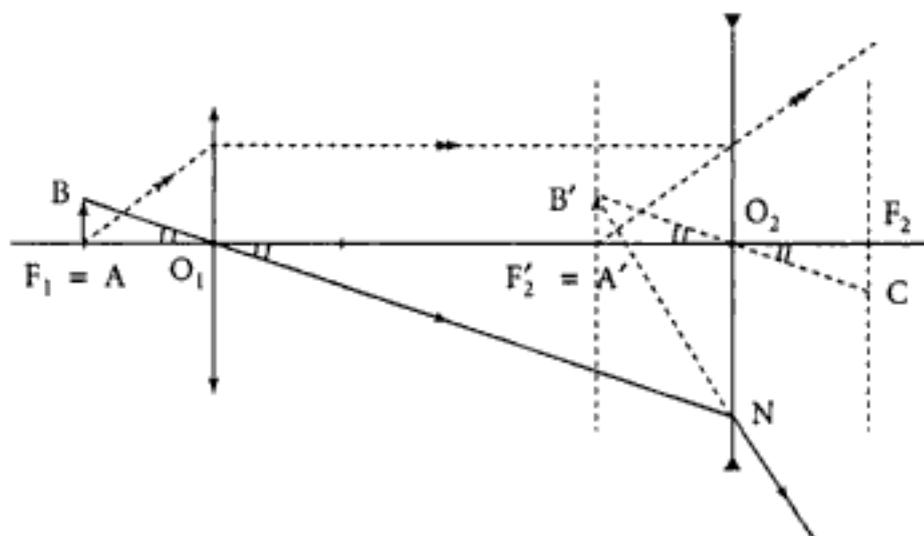
Le point B appartient au plan focal objet de  $\mathcal{L}_1$ , il a donc une image par rapport à  $\mathcal{L}_1 \cup \mathcal{L}_2$  située dans le plan de front de  $F'_2$  (B est dans le plan de front de  $F_1$ ).
