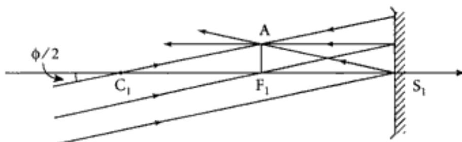
Le faisceau de rayons parallèles issu d'un point du bord de l'objet arrive en faisant l'angle  $\frac{\phi}{2}$  avec l'axe du miroir, et se réfléchit en un faisceau convergent au point  $A$ .
