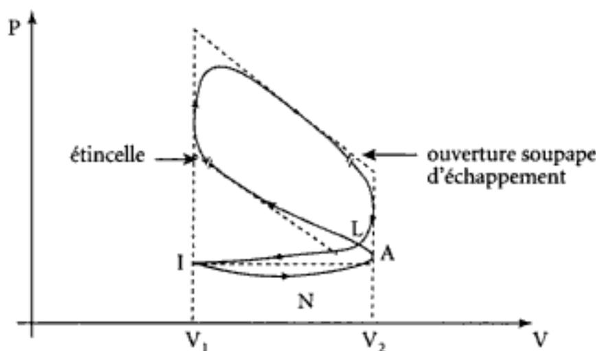
– Les compression et détente ne sont pas isentropiques (les parois du cylindre cèdent de l'énergie thermique au mélange pendant la phase de compression et en reçoivent de la part des gaz de combustion pendant la phase de détente : ceci a pour effet de diminuer les performances du moteur).
