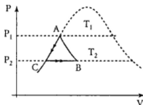
■ Pour calculer la variation d'entropie massique, reprenons le chemin réversible  $A \rightarrow C \rightarrow B$ :  $\Delta s = \Delta s(A \rightarrow C) + \Delta s(C \rightarrow B)$ , avec :
