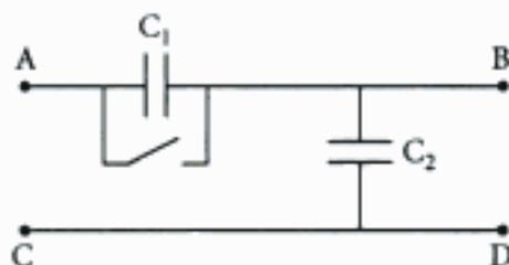
$$\text{D'où : } \underline{H} = \frac{Z_2}{Z_2 + Z_1} = \frac{Y_1}{Y_2 + Y_1} = \frac{jC_1\omega}{jC_2\omega + jC_1\omega} \quad \text{et} \quad \underline{H} = \frac{C_1}{C_1 + C_2}.$$
