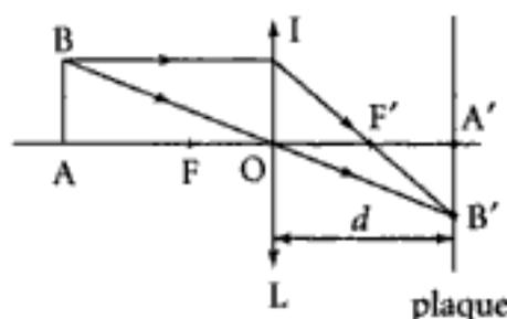
Dans le cas de figure,  $B'$  est réel ; il est virtuel lorsque  $BO$  coupe le prolongement (à gauche de  $L$ ) du rayon  $IF'$ . Il faut donc que  $A$  soit à gauche de  $F$  ( $\overline{FA} < 0$ ) ce qui implique (relation de conjugaison de Newton :  $\overline{FA} \cdot \overline{F'A'} = -f'^2 < 0$ ) que  $A'$  est à droite de  $F'$ ...
