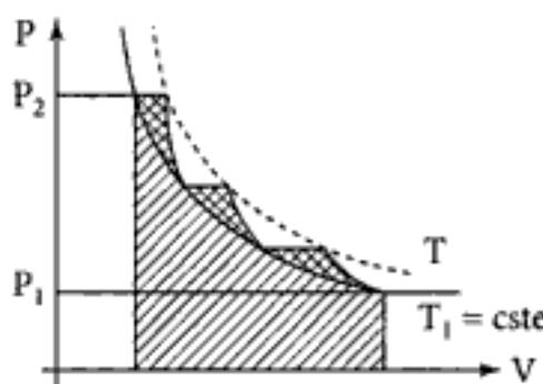
En augmentant les étapes de compression, on diminue l'échauffement à chaque étape, donc l'écart de température avec l'extérieur. On réduit de ce fait l'irréversibilité des échanges thermiques avec l'extérieur à  $T_1$ , ce qui rapproche du cas réversible (cas optimal  $W = W_m$ ).
