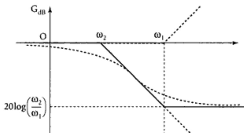
$$\text{En effet : } \omega \ll \omega_2 \text{ et } \omega_1 \quad G_{dB} \rightarrow 0 + 0 = 0$$
