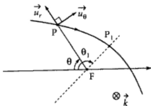
avec  $p = \frac{L_0^2}{mK}$  soit  $p = \frac{mb^2V_0^2}{K}$  et  $e^2 = 1 + \frac{2L_0^2 E_m}{mK^2}$ .
