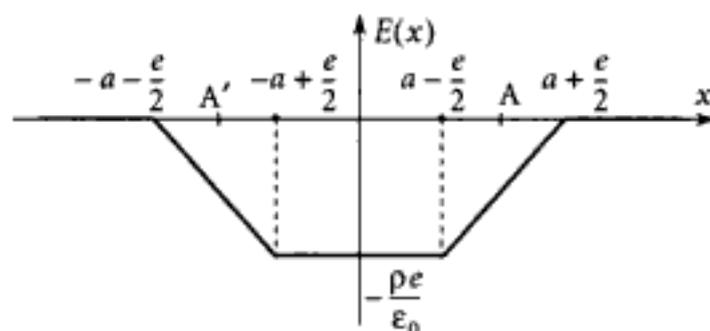
• La fonction potentiel s'en déduit aisément à partir de la relation  $\frac{dV}{dx} = -E(x)$ .
