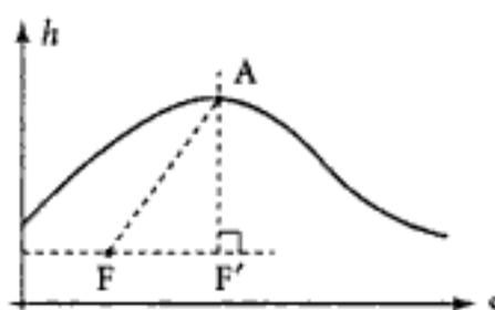
4. Considérons une turbine et la masse  $\delta m$  la « traversant » entre les instants  $t$  et  $t + dt$  (le régime étant stationnaire, la même masse  $\delta m$  entre et sort entre ces deux instants).
