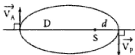
La trajectoire elliptique ayant une excentricité proche de 1, il est possible de substituer à la vraie valeur de  $V$  celle calculée au 1. dans le cas de la trajectoire parabolique.
