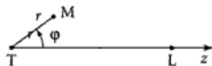
**2. b.  $\beta$**  Le champ gravitationnel  $\vec{G}_1$  peut être également associé au potentiel  $V_1 = -\frac{\mathcal{G}m_T}{r}$ . L'équation (5) traduisant « l'équilibre » de la masse d'eau  $\delta m$  devient ( $\rho_0 = \text{cste}$ ) :
