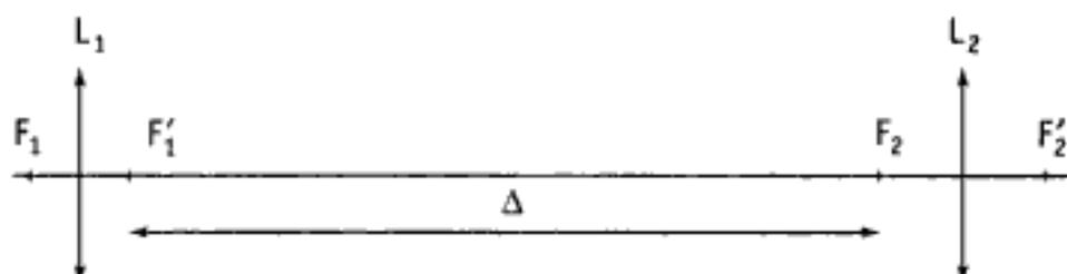
Pour les applications numériques, on prendra  $L_1$  et  $L_2$  de distances focales respectives  $f'_1 = 1,2$  cm et  $f'_2 = 2$  cm. On notera  $\Delta$  la distance entre le foyer image de  $L_1$  et le foyer objet de  $L_2$ , avec  $\Delta = 18$  cm.
