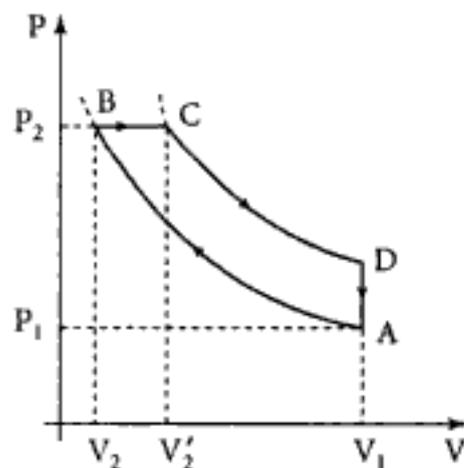
Nous avons  $r = \frac{V'_2}{V_2} = \frac{V'_2}{V_1} \cdot \frac{V_1}{V_2} = \frac{\alpha}{\beta}$  soit :
