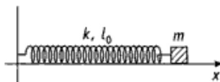
Une masse  $m$  peut glisser sans frottements sur l'axe  $x'Ox$  d'un plan horizontal. Elle est reliée à un ressort de raideur  $k$  et de longueur à vide  $l_0$ . On repère son mouvement  $x(t)$  par rapport à sa position ressort ni tendu ni comprimé. Elle est de plus soumise à une force de frottement fluide  $\vec{f} = -2\lambda m \dot{x} \vec{u}_x$  ( $\dot{x} = \frac{dx}{dt}$ ).
