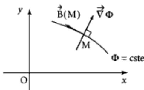
Il en résulte que les lignes de champ (de  $\vec{B}$ ) se confondent avec les « équipotentielles »  $\Phi = \text{cste}$ .
