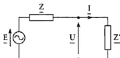
La puissance reçue par  $\underline{Z}'$  est  $P = \frac{1}{2} I^2 \cdot \text{Re}\{\underline{Z}'\}$ .
