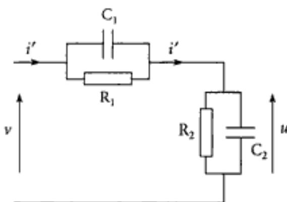
Dans le cas où  $R_1 C_1 = R_2 C_2$ , il vient :
