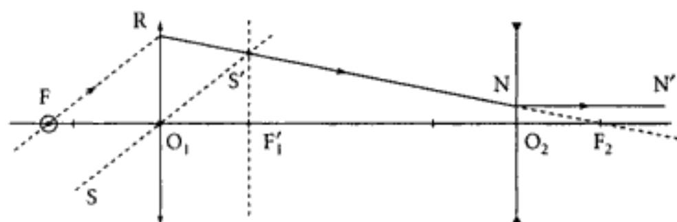
La construction peut se faire en sens inverse. Étant donné le rayon émergent  $NN'$ , parallèle à l'axe, on construit le rayon incident pour  $\mathcal{L}_2$ ,  $RN$ , dont le prolongement passe par  $F_2$ . Ce rayon coupe le plan focal image de  $\mathcal{L}_1$  en  $S'$ , foyer image secondaire. Il suffit alors de tracer la droite  $FR$ , parallèle à  $O_1 S'$  (les rayons incidents parallèles  $SO_1$  et  $FR$  convergent nécessairement en  $S'$ ,  $SO_1$  n'étant pas dévié).
