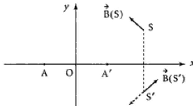
**A. 1. b.** • Au voisinage de A (respectivement de A'), l'influence du fil traversant le plan  $xOy$  en A (respectivement en A') est prépondérante et on aura des lignes de champ entourant A (respectivement A').
