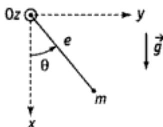
1. Donner l'équation du mouvement en  $\theta(t)$ . On posera  $\omega = \sqrt{\frac{g}{l}}$ . On se limite, par la suite, à l'étude des petits mouvements par rapport à la position d'équilibre stable  $\theta = 0$ .
