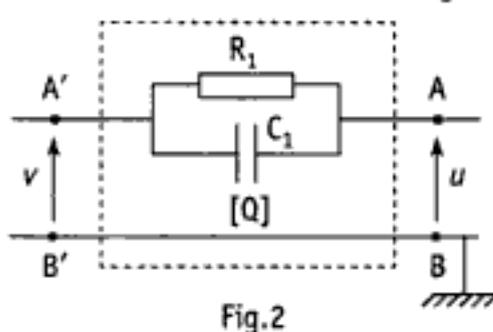
c. Le quadripôle [Q] représente une sonde de mesure que l'on intercale entre le dipôle où l'on prélève la tension et l'entrée de l'oscilloscope.
