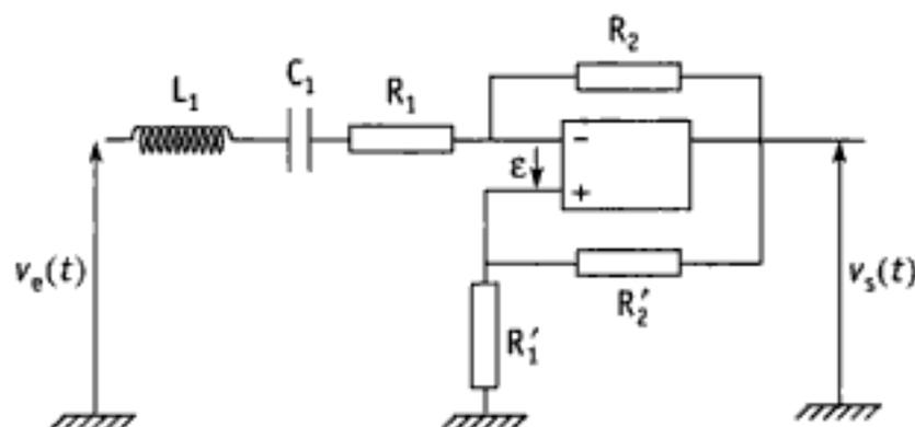
1. Un générateur parfait impose une tension sinusoïdale  $v_e(t)$ . Caractériser la nature du montage. On supposera que l'AO idéal fonctionne en régime linéaire ( $\epsilon = 0$ ).
