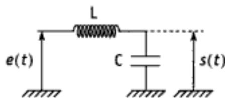
b. On note  $s(t) = R_e(\underline{s}(t))$  et  $e(t) = R_e(\underline{e}(t))$  avec  $\underline{s}(t) = \underline{S}e^{j\omega t}$  et  $\underline{e}(t) = \underline{E}e^{j\omega t}$ .
