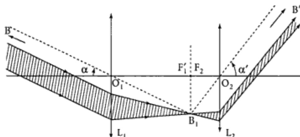
Le rapport  $\frac{\alpha'}{\alpha}$  se calcule immédiatement dans les triangles  $O_1F_1'B_1$  et  $O_2F_2B_1$  ( $F_2 = F_1'$ ) :
