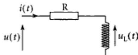
Les conditions initiales imposent ici  $i(0^+) = 0$  (continuité du flux et donc de l'intensité dans la bobine). Dans un premier temps, la tension de sortie du générateur sera fixée à  $E_0$  (point  $P_0$  de la caractéristique :  $i = 0$  et  $u = E_0$ ).
