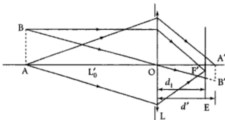
Si A est à la distance  $L'_0$  de (L), la tache dans le plan de (E) est de diamètre  $g$ , et les triangles semblables donnent encore :
