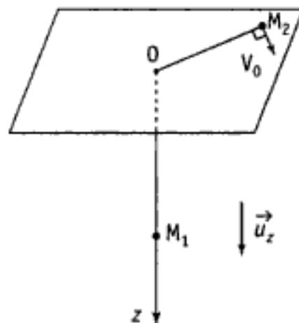
Le mouvement est repéré pour le point  $M_1$  par sa cote  $z(t)$  et pour  $M_2$  par ses coordonnées polaires  $r(t) = OM_2$  et  $\theta(t) = (\vec{u}_x, \vec{OM}_2)$ .
