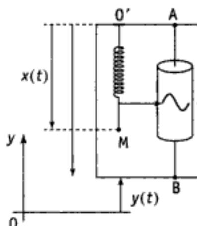
On suppose que le bâti subit dans  $\mathcal{R}_0$  des oscillations sinusoïdales de pulsation  $\omega$  :  $y(t) = Y_m \cos \omega t$ .
