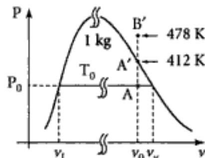
3. Les résultats des questions 2. a. et 2. b. nous montrent que l'énergie thermique fournie par le thermostat est plus grande pour la transformation à pression constante que pour la transformation à volume constant :
