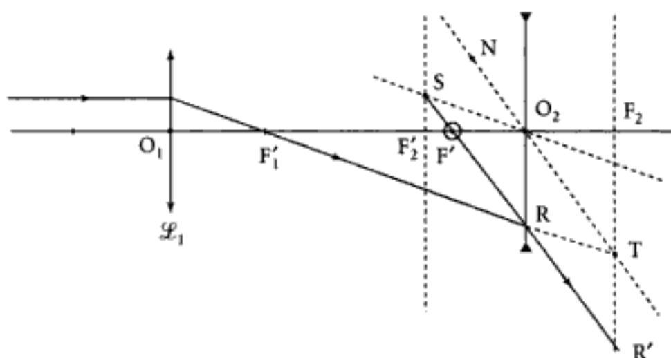
Un rayon parallèle à l'axe converge vers  $F'_1$  après la traversée de  $\mathcal{L}_1$ . Pour dessiner le rayon émergent de  $\mathcal{L}_2$ , on considère le rayon « fictif »  $SO_2$  parallèle à  $F'_1 R$ ,  $S$  appartenant au plan focal image de  $\mathcal{L}_2$ . Les rayons parallèles  $SO_2$  et  $F'_1 R$  donnent après la traversée de  $\mathcal{L}_2$  des rayons émergents dont les prolongements passent par  $S$  (foyer image secondaire).
