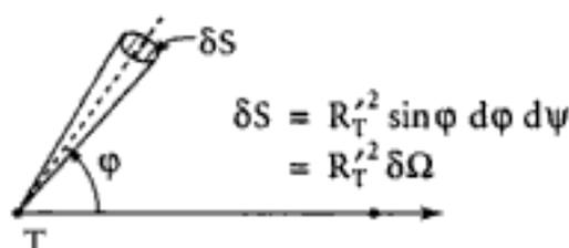
$s$  ne dépendant que de  $\varphi$  on peut prendre  $\delta\Omega = 2\pi \sin\varphi d\varphi$  ( $\varphi : 0 \rightarrow 2\pi$ ), d'où :
