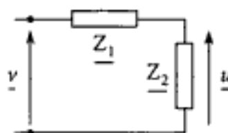
D'où  $\frac{\underline{v}}{\underline{u}} = 1 + \frac{\underline{Z}_1}{\underline{Z}_2}$  avec
