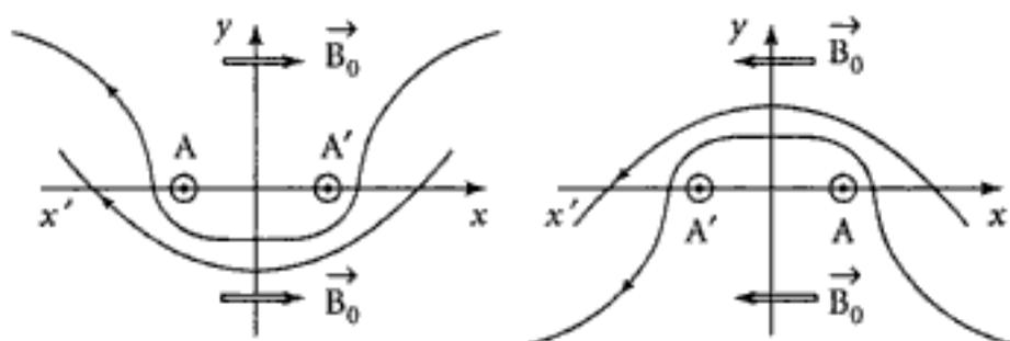
Enfin, il est à noter que pour  $I_1 = I_2 = I_0 > 0$ , on a ici  $B_0 > 0$ . Pour s'en convaincre, il suffit de prendre en compte la ligne de champ qui coupe l'axe Ox en un point N tel que  $ON > OA'$ .
