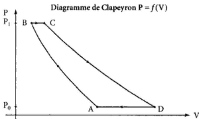
2. Pour les transformations adiabatiques,  $Q_{A \rightarrow B} = Q_{C \rightarrow D} = 0$ .Pour les transformations isobares  $Q = \Delta H$
