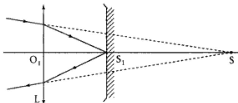
$S_1$  est donc l'image à travers  $L$  du point  $S$  intersection du rayon incident avec l'axe.
