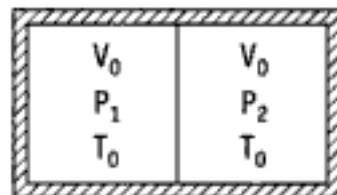
1. On libère le piston, qui devient parfaitement mobile, et on laisse l'équilibre se réaliser. Déterminer l'état final et la variation totale d'entropie.
