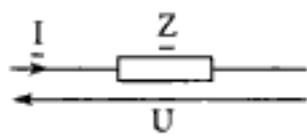
La puissance moyenne reçue par un dipôle d'impédance complexe  $\underline{Z}$ , soumis à une tension sinusoïdale  $u = U \cos \omega t$  et parcouru par un courant  $i = I \cos(\omega t + \varphi)$  s'écrit :
