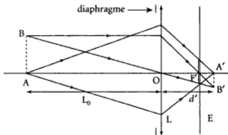
ce qui correspond dans le plan (E) – plan de front de  $F'$  – à une tache d'autant plus grande que le diaphragme a une valeur  $N$  plus petite. Pour un diamètre  $\phi$  du diaphragme, la tache dans le plan E doit avoir un diamètre maximal égal à  $g$ , soit, avec  $OA' = d'$  et  $OF' = f'$
