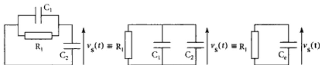
avec  $C_e = C_1 + C_2$ , d'où la constante de temps  $\tau_2 = R_1 C_e = R_1 (C_1 + C_2)$ .
