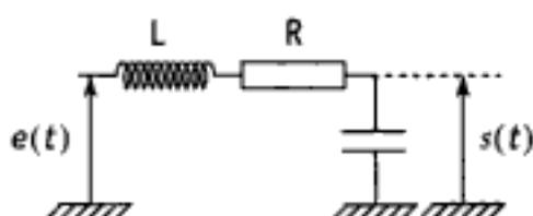
a. Déterminer la nouvelle fonction de transfert  $\underline{H}' = \frac{\underline{S}}{\underline{E}} = |\underline{H}'|e^{j\psi'}$  en fonction de  $Q$  et de  $\frac{\omega}{\omega_c}$  (régime sinusoïdal établi).
