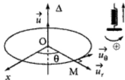
Le mouvement circulaire étudié ici est caractérisé par le vecteur rotation  $\vec{\Omega} = \dot{\theta}\vec{u}$ , et  $\vec{V}'(B) = \vec{V}(B)/\mathcal{R}' = \vec{\Omega} \wedge \vec{CB}$ . D'après la loi de composition des vitesses :
